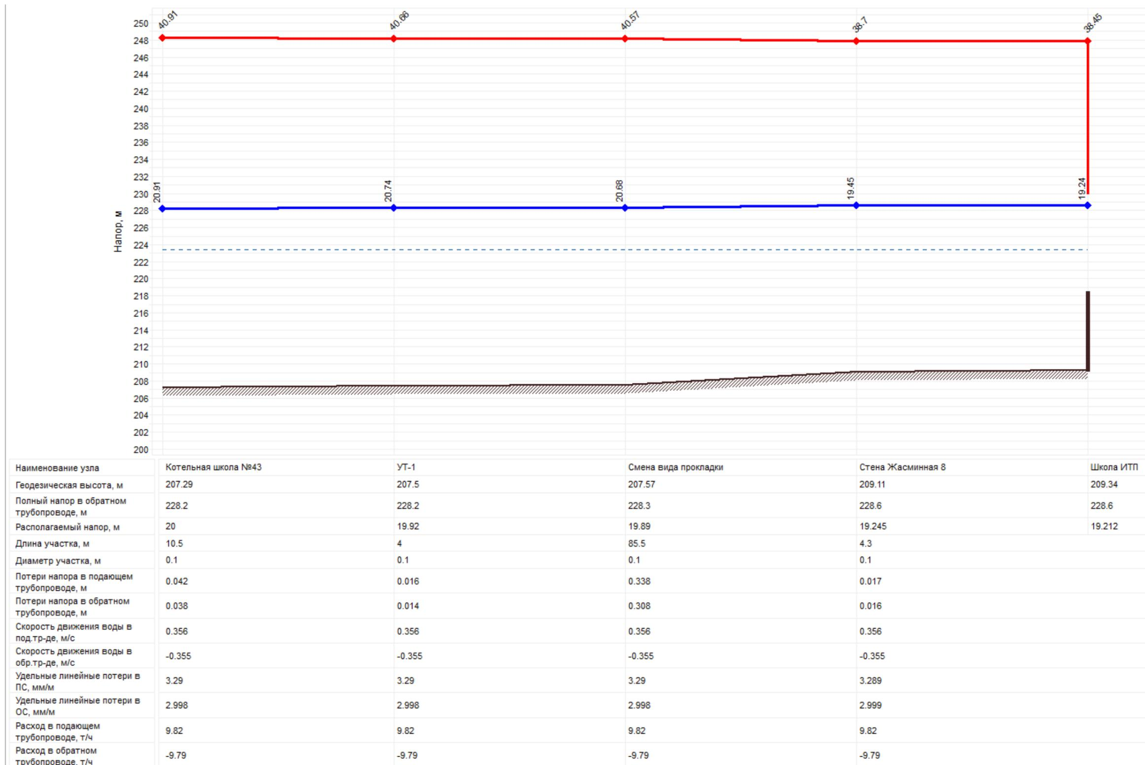
Рисунок 167. Пьезометрический график котельной школа 43-школа ИТП
