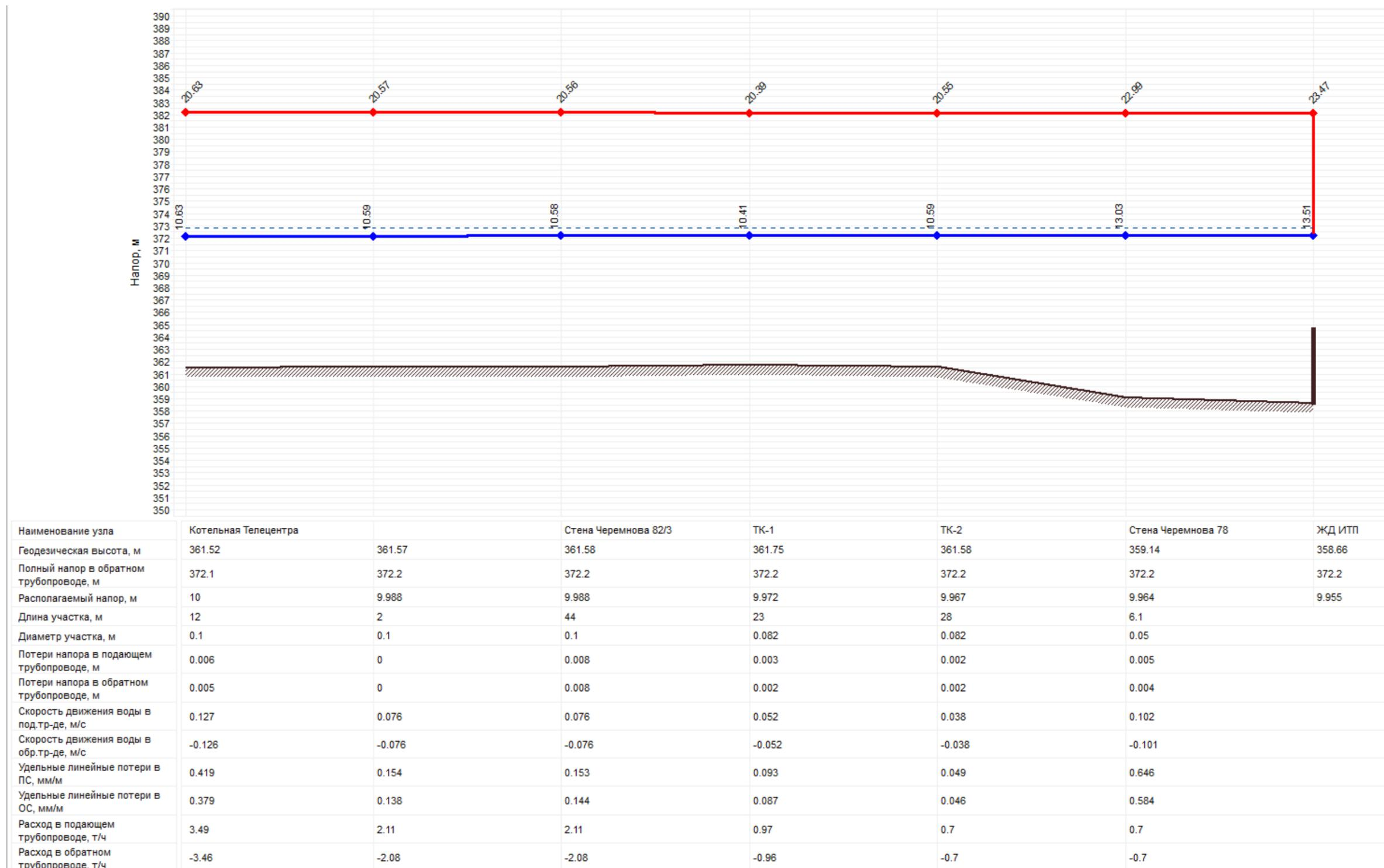
Рисунок157. Пьезометрический график котельной РТРС – ЖД ИТП
