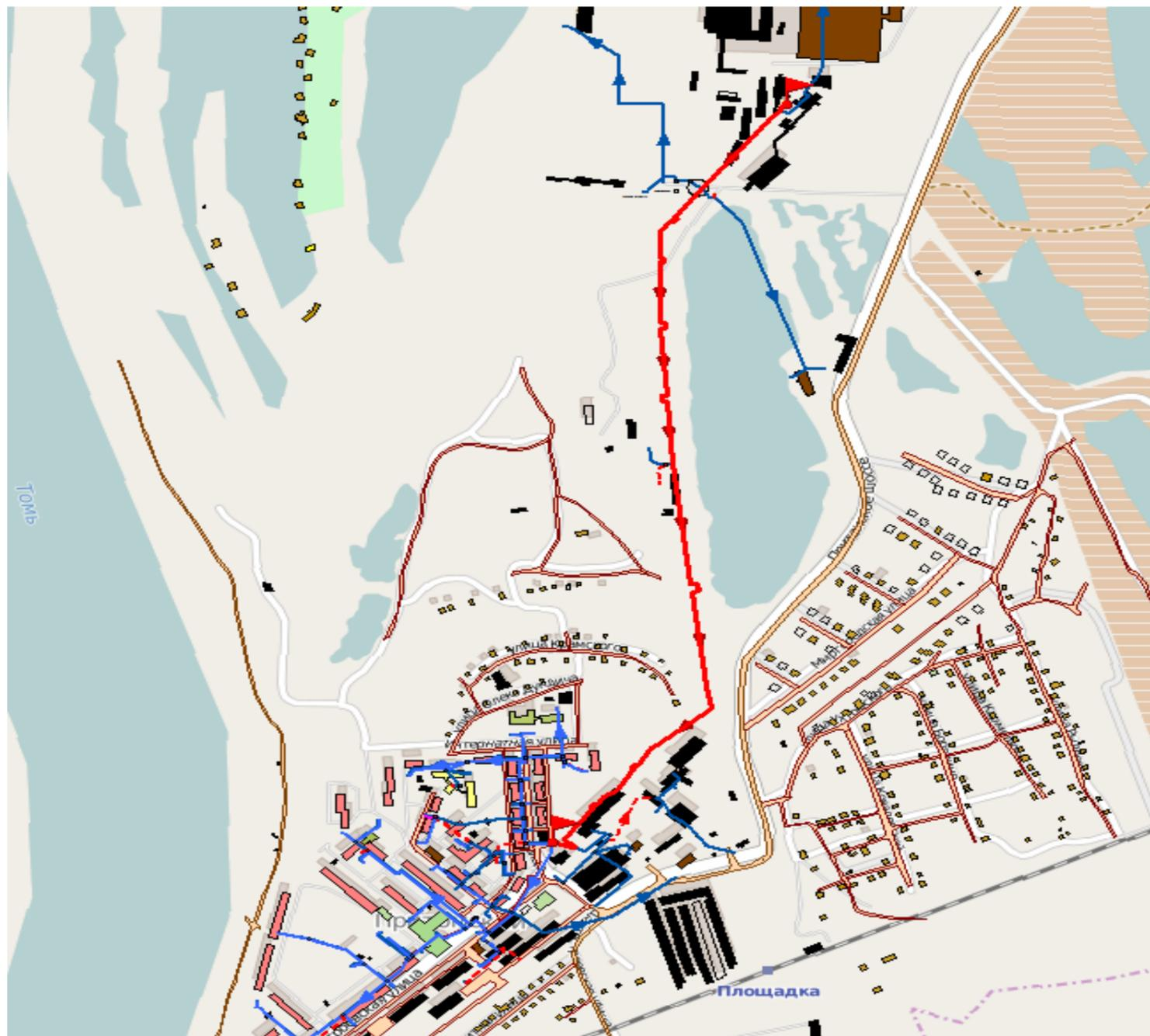
Рисунок 111. Путь построения пьезометрического графика котельной п.Притомский – ТК-2
