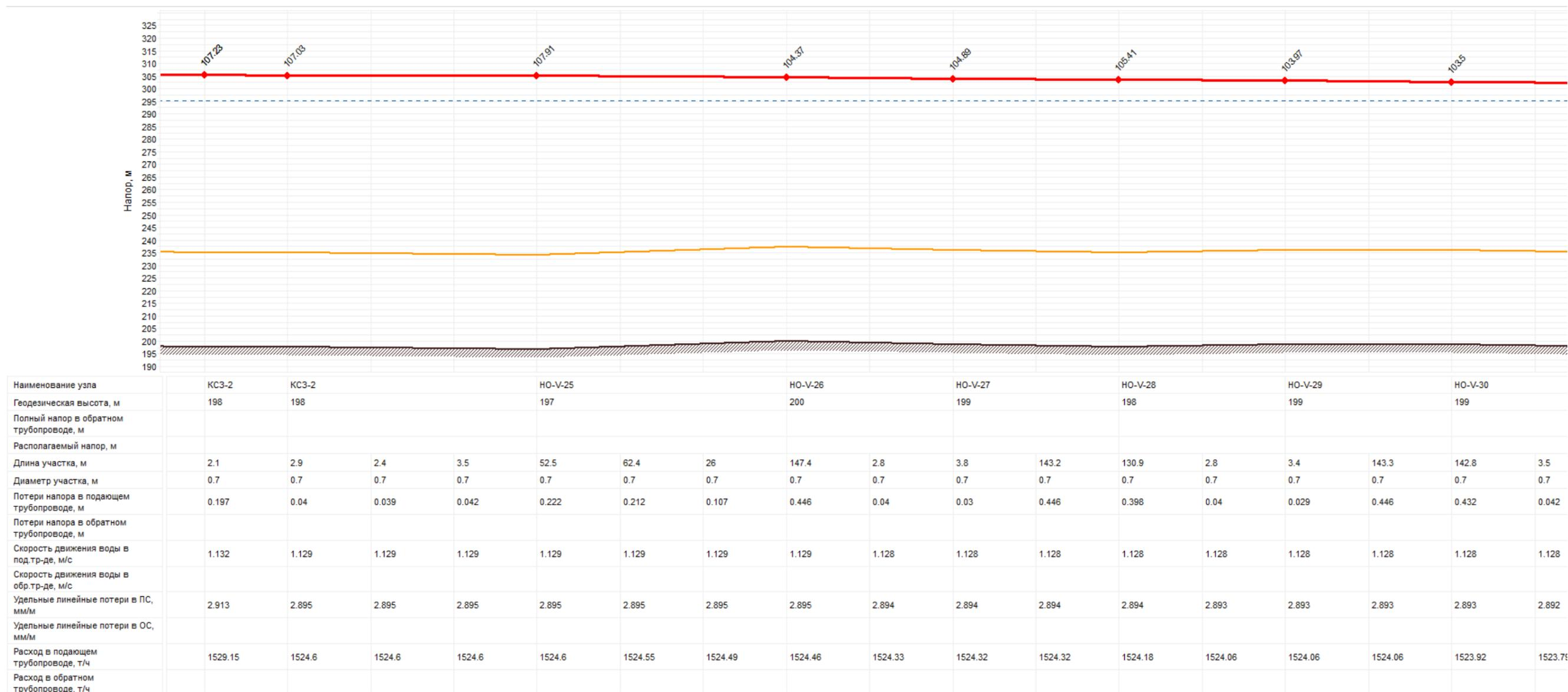
Рисунок 35. Пьезометрический график НО-V-24 – НО-V-30 (Магистраль №1)
