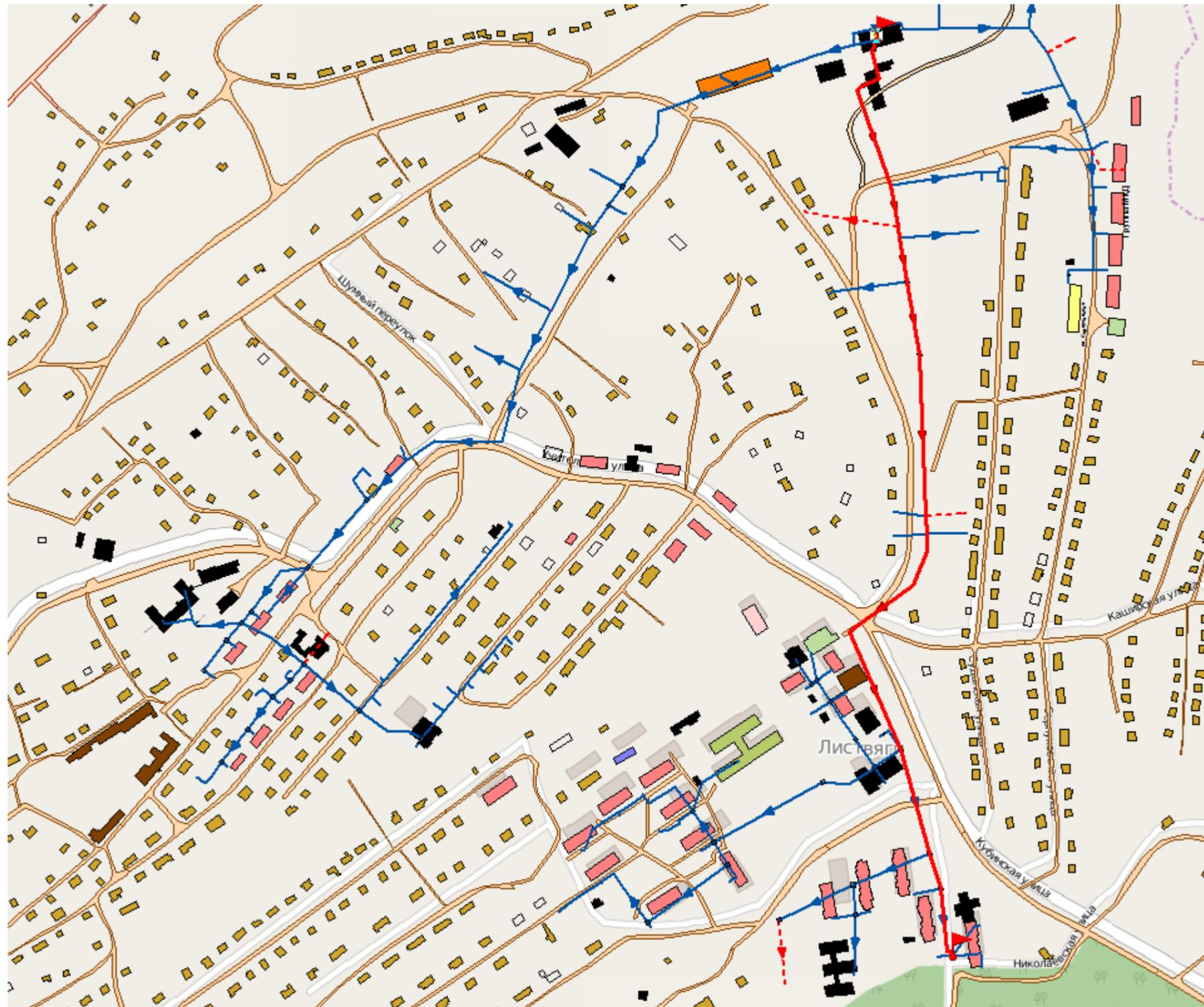
Рисунок132. Путь построения пьезометрического графика котельной Листвяги – ТК-20( Магистраль №1)
